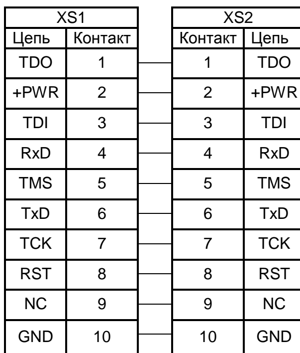
XS1, XS2 – Разъемы типа IDC-10-G
